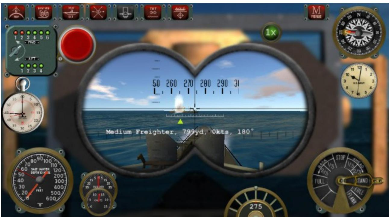
Der TBT Targe Bearing Indicator **(6)** auf deutschen U-Booten UZO genannt erfüllt die gleiche Funktion wie das Periskop und wird ausschließlich im aufgetauchten Zustand verwendet. Der Vorteil des TBT ist zum einem die Funktion als Fernglas sowie die Ausnutzung der höheren Geschwindigkeit und Manövrierbarkeit des U-Bootes bei der Verfolgung und Abwehr von Überwasserzielen.
